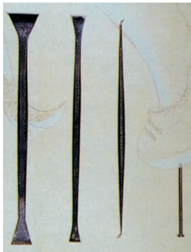
I ferri che vengono utilizzati per sgraffiare gli strati di intonaco
